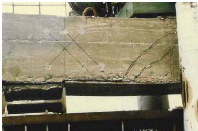
**Figura 8:** Tipica fessurazione a taglio di una trave reticolare mista: distacco del fondello e fessurazione inclinata [7].
