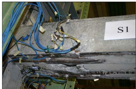
Figura 32. Espulsione del calcestruzzo e taglio di un angolare.
