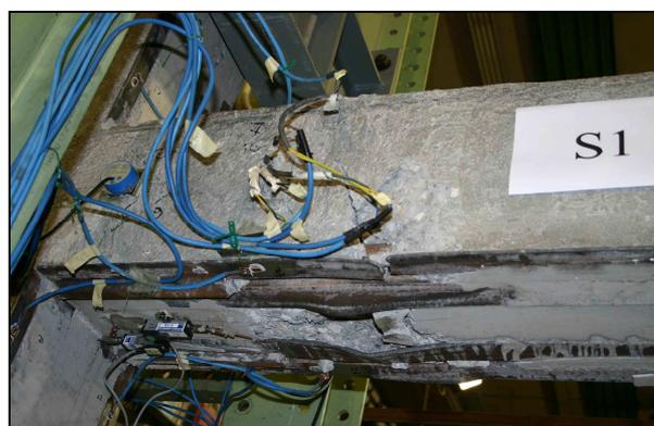
**Figura 27.** Espulsione del calcestruzzo e taglio di un angolare
