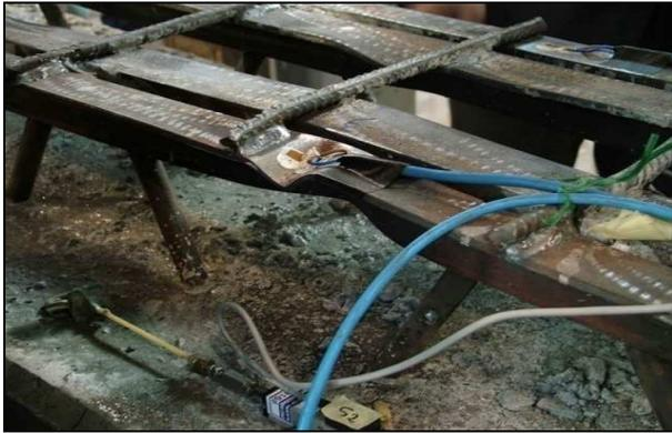
**Figura 14.** Particolare instabilità locale corrente compresso
